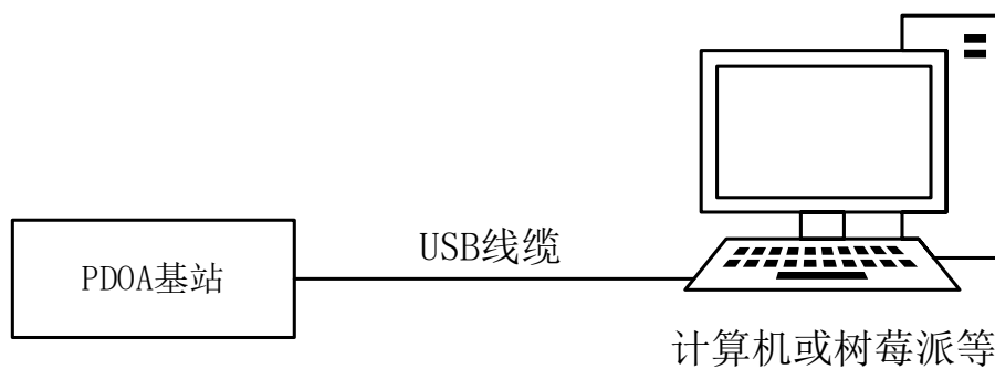
图 6-4 模块连接 PC 示意图
